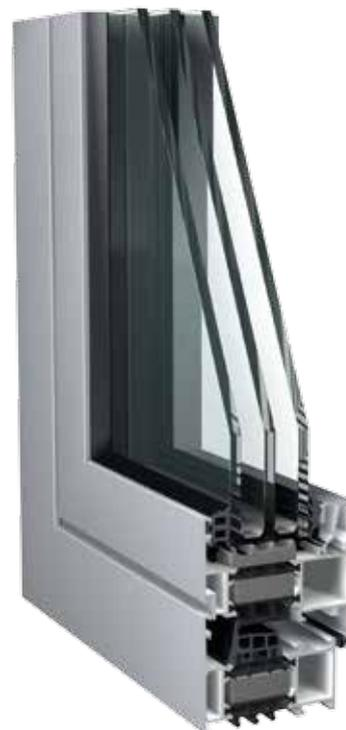
Darstellung entspricht  $U_f = 1,4 \text{ W/m}^2\text{K}$ ,  $U_w = 0,9 \text{ W/m}^2\text{K}$  mit Fenstergröße  $1,3 \times 1,8 \text{ m}$ ,  $U_g = 0,5 \text{ W/m}^2\text{K}$ ,  $\Psi = 0,065 \text{ W/m}^2\text{K}$
